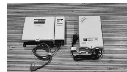
▲テレビ難視聴世帯に設置している受信装置
