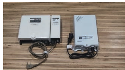
▲テレビ難視聴世帯に設置している受信装置
