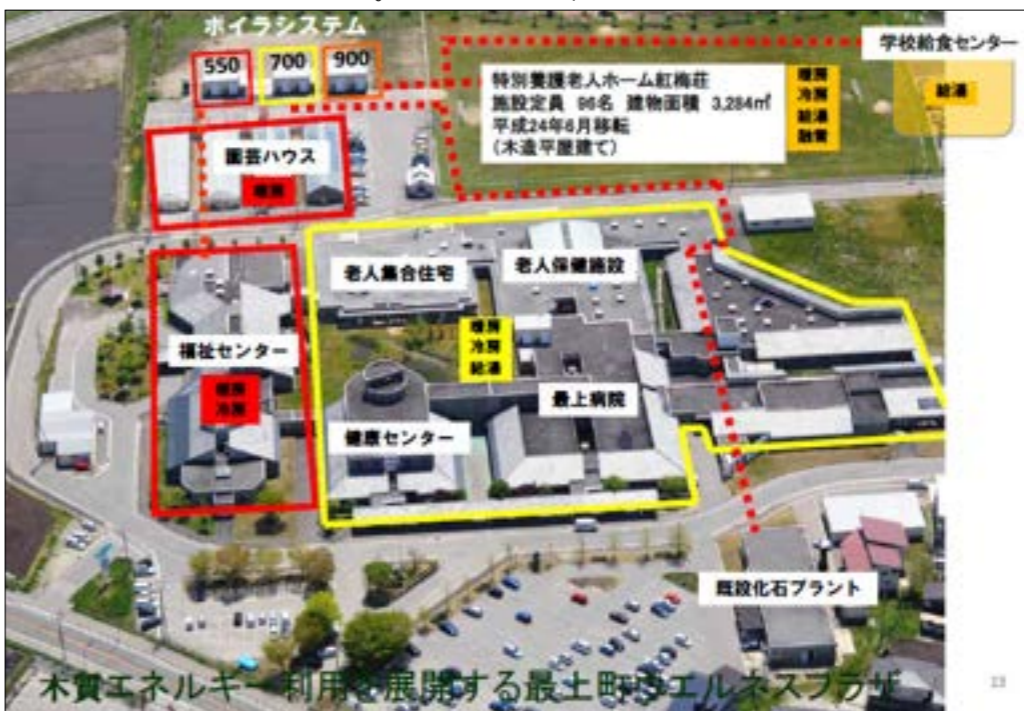
▲集約化された福祉・医療施設に木質バイオマスボイラーによる冷暖房と給湯が供給されている最上町ウエルネスプラザの施設写真
