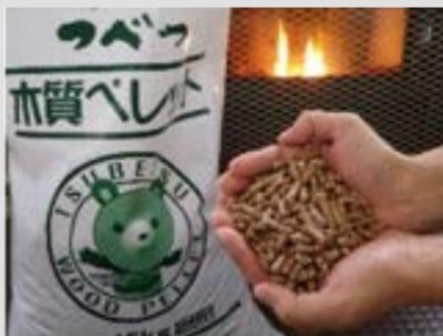
木質ペレットとは、乾燥した木材を細粉し、圧力をかけて円筒形に圧縮成形した木質燃料で、主にストーブやボイラーの燃料として利用されています。
