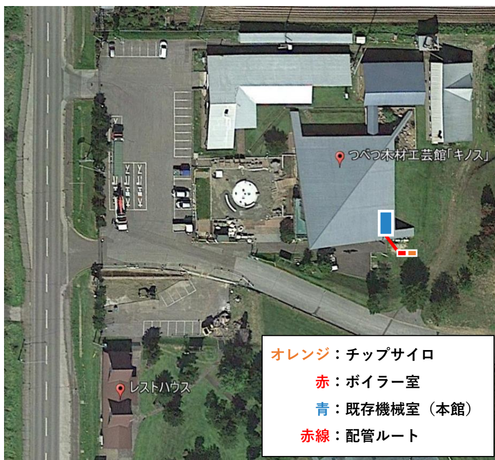
図 3-20 つべつ木材工芸館「キノス」の木質バイオマスボイラー導入のレイアウト例
