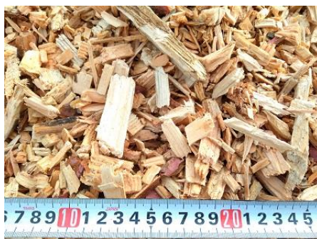
図 3-15 津別町内の追い上げ材を破碎したチップ
