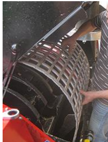
図 3-13 ウッドターミネーター9XL（クローラー式）の内部構造 （左：ドラム、右：スクリーン）
