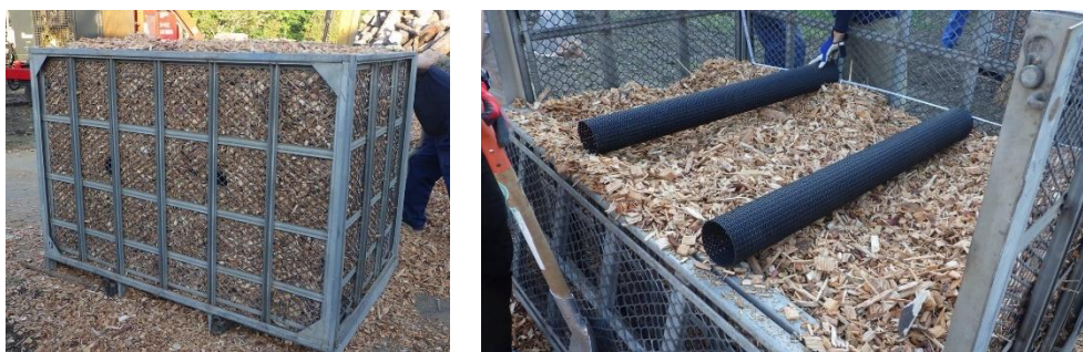
図 2-15 ②暗渠排水管の設置（主風方向に対して平行）
