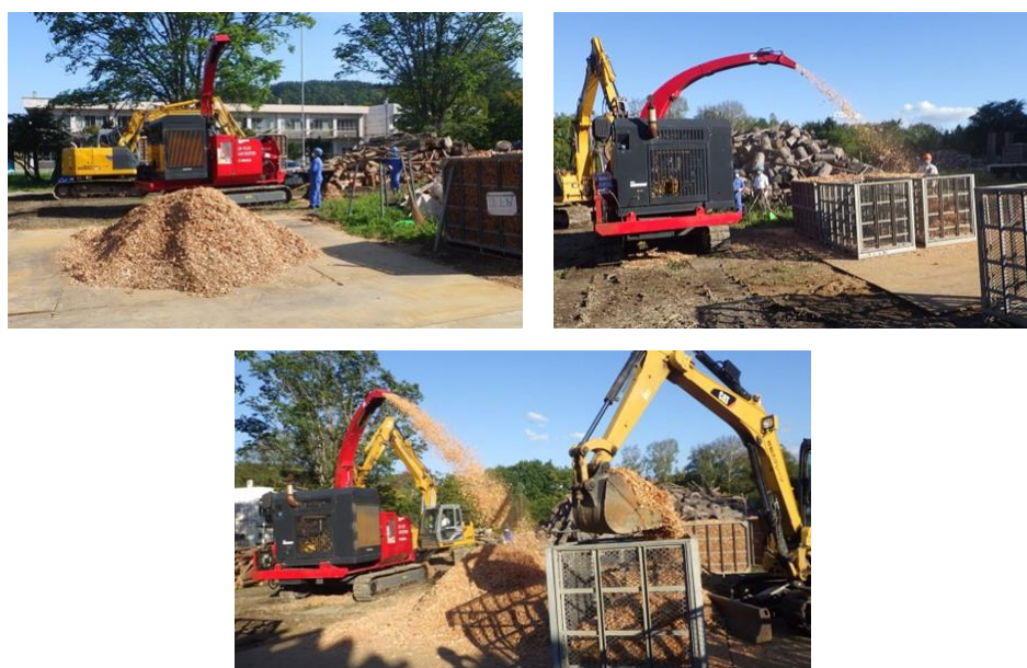
図 2-9 チップ化の試験風景
