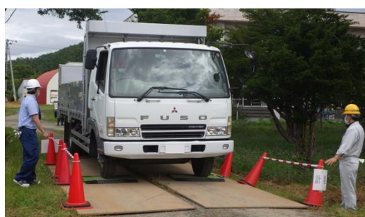
図 2-6 持ち運び可能なポータブルトラックスケール（模擬開催時の重量計測機器）
