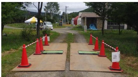
図 2-6 持ち運び可能なポータブルトラックスケール（模擬開催時の重量計測機器）
